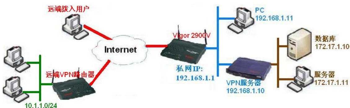
图 3. 在Vigor 2900V上设置VPN pass-through
